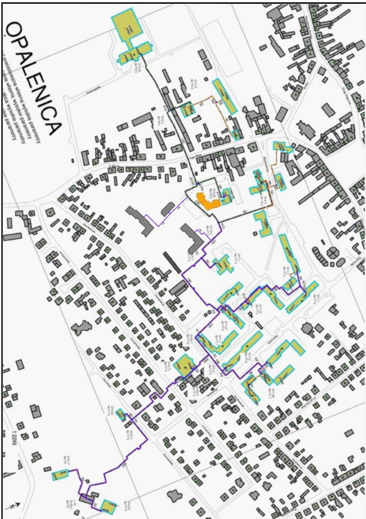
Rysunek 8. Schemat sieci ciepłowniczej na terenie Opalenicy
